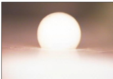
4 Benetzungsversuch: Ungünstige Benetzung (oben) und Benetzung der CBN-äquivalenten Oberfläche mit der HPB-Bindung (unten)
